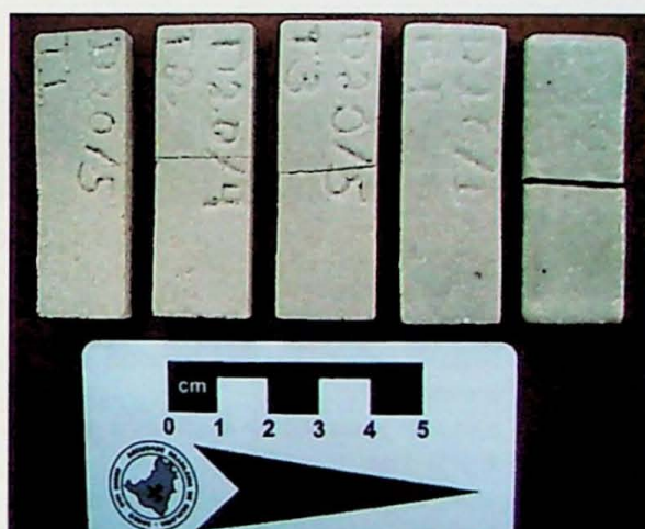
Figura 40. Aumento na sinterização dos corpos-de-prova com aumento da temperatura (esquerda para direita).
