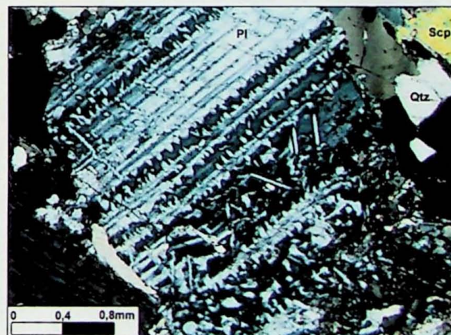
Fotomicrografia 6. Plagioclásio apresentando padrão de exsoluções segundo a lacuna de Voll (An55-An80). Amostra: LK-08A. Pol X.
