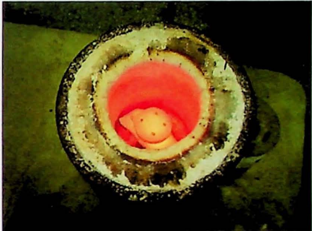
Figura 31. Início da fusão dos cones pirométricos
