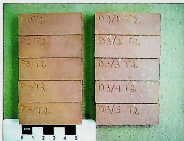
Figura 44. Sutil branqueamento da formulação M7 (que apresenta pontos brancos), em relação à massa M6 que não recebeu adição do diopsidito, sinterizados na temperatura de 1030°C.
