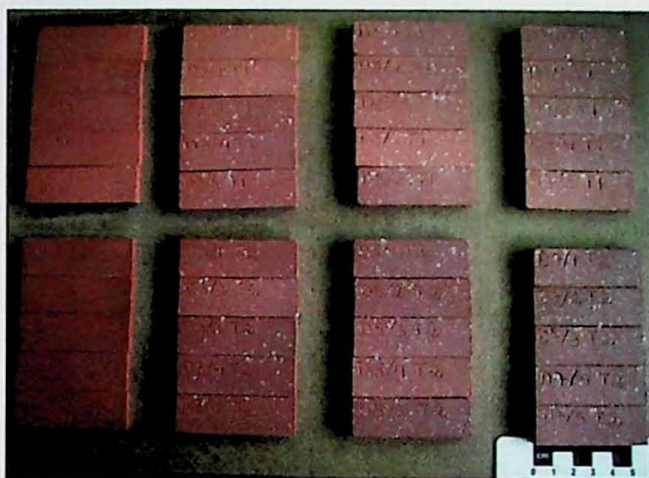
Figura 43. Verifica-se visualmente, que o diopsidito não reagiu de forma efetiva nas temperaturas de queima escolhidas (presença de pontos brancos nos corpos-de-prova)
