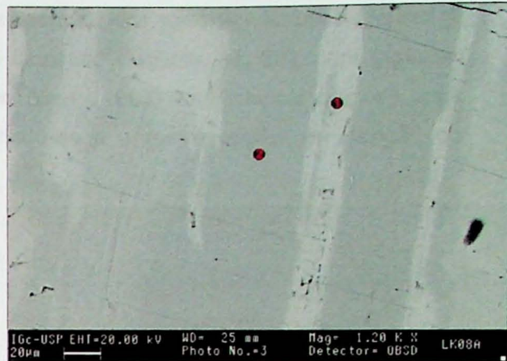
Figura 22. Fases presentes nos plagioclásios, analisados por MEV/EDS. Amostra: LK-08A
